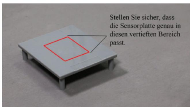
kann. Befolgen Sie die folgenden Schritte für eine korrekte Kalibrierung. Die Anweisungen sind auch auf der Rückseite des Kalibrators aufgedruckt. Stellen Sie den Kalibrator auf seine Beine auf einer nichtmetallischen Oberfläche.
