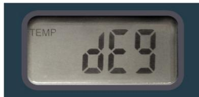
**NOTA:** La visualización de la temperatura se puede cambiar a Celsius (por ejemplo, 24.0C) presionando la tecla de flecha arriba o abajo. A no presionar el botón SPECIES/MATERIAL, los modos de
